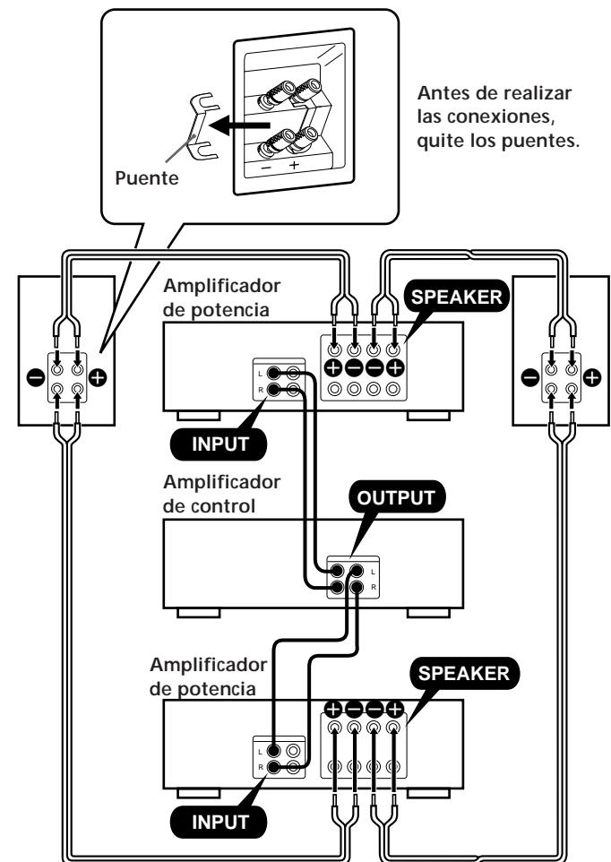
Conecte el conductor marcado con una línea (letras, etc.) al terminal "+".
